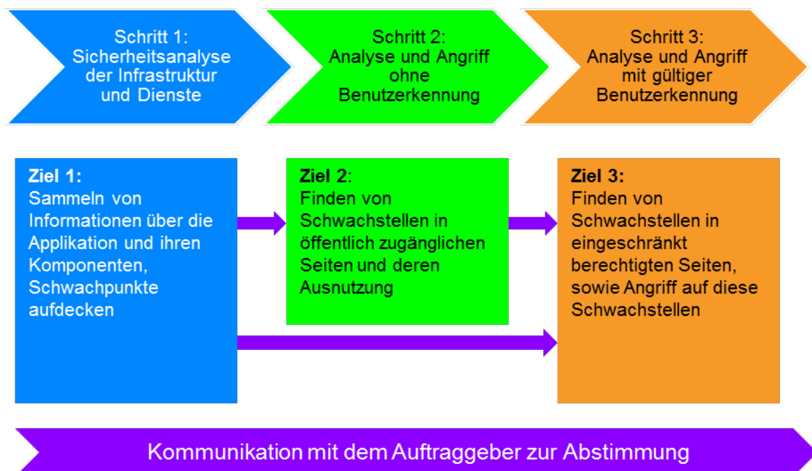
Abbildung 5: Beispiel eines abgestimmten Penetrationstests. Ergänzend sind unter anderem Softwarelieferkette, Updates und Wiederherstellung zu prüfen.
